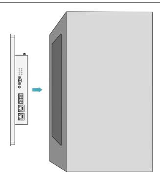
4. 将卡扣的螺丝孔对准设备侧的卡扣安装孔。
