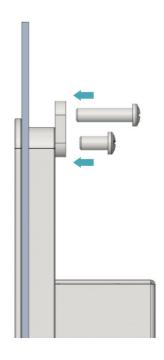
5. 使用 4 颗 M4x8 螺钉穿过卡扣顺时针拧紧,将卡扣固定至设备上;再使用 4 颗 M4x16 螺钉穿过卡扣顶住机柜内侧顺时针拧到底。
